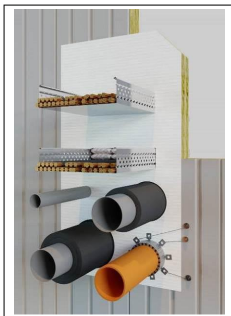
Figura A.3.4.1: Esempio di sigillatura con l'AF PANEL in una parete in pannelli sandwich EI 120.
