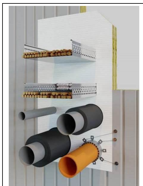
Figura A.3.4.1: Ejemplo de sellado con AF PANEL en una pared de paneles sándwich EI 120.
