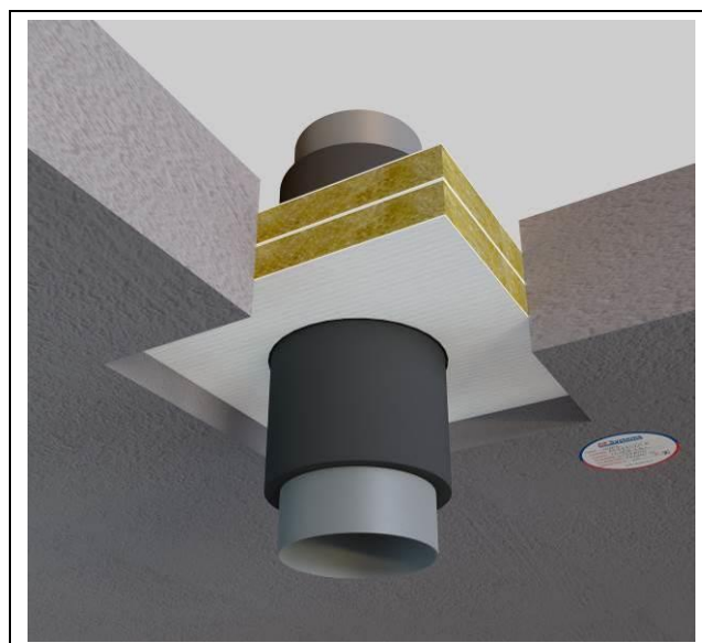
Figura A.4.1.2: Ejemplo de sellado con AF PANEL en un suelo rígido (C).
