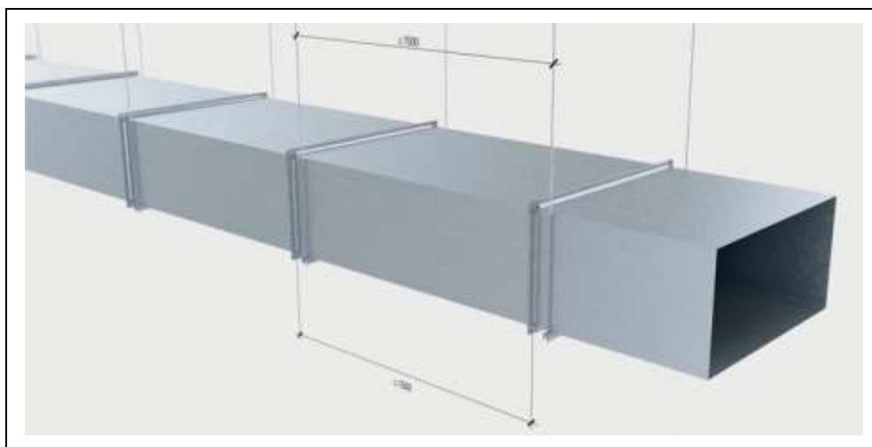
Figura B.1: Vista general del conducto de acero y de los elementos de suspensión.
