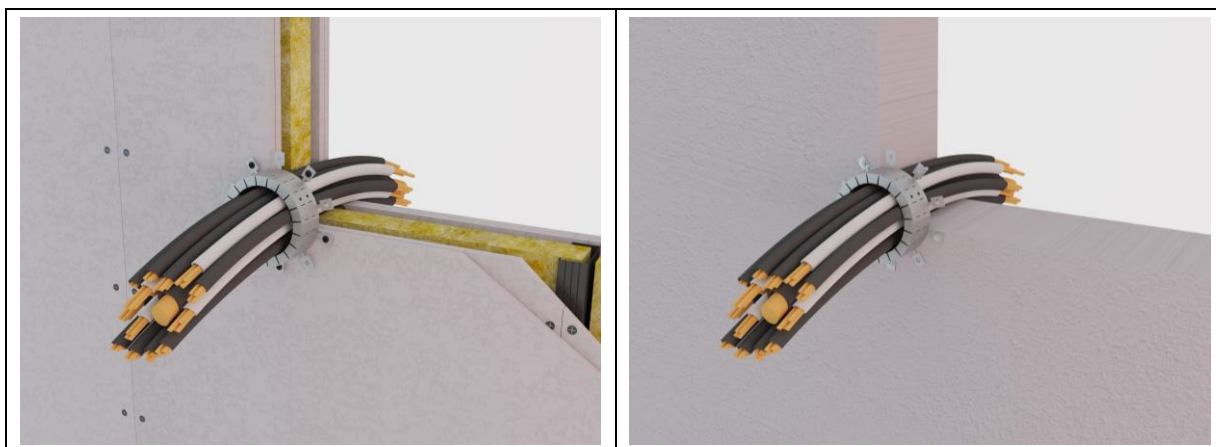
Figura B.6.1: Ejemplo de sellado de penetración de cables recubiertos pequeños en una pared flexible o rígida.
