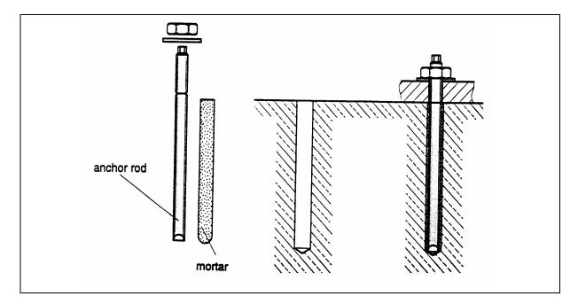
(d) Example of bonded anchors (Part 5)
