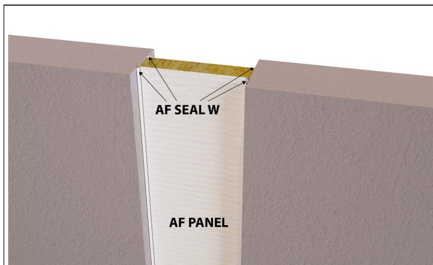
Figura A.2: Sellado de junta lineal vertical con capa simple en paredes.
