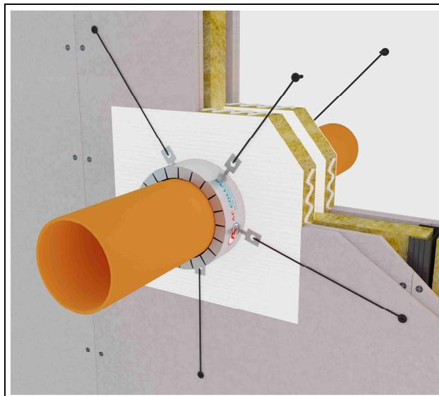
**Figura B.2.3.1:** Esempio di un AF Collar fissato con cavi d'acciaio ad una parete.
