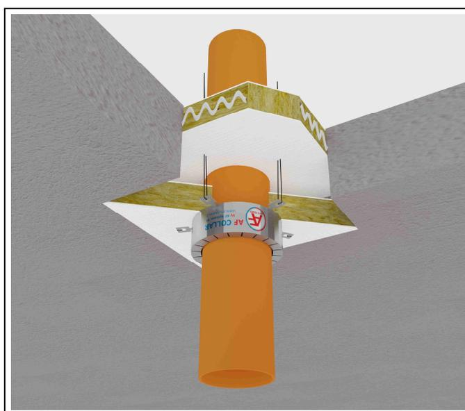
**Figura B.2.3.2:** Esempio di un AF Collar fissato con cavi d'acciaio ad un solaio.
