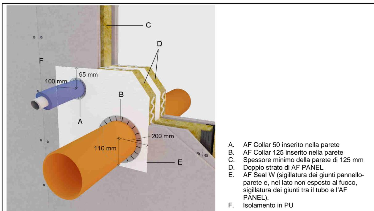
**Figura B.2.3.4:** Sigillatura di attraversamenti di tubazioni doppie in una parete con una cavità chiusa con un doppio strato di AF PANEL.
