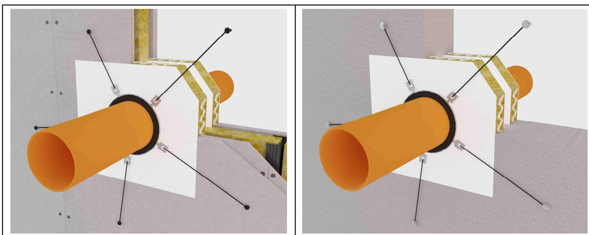
**Figura B.2.3.3:** Esempio di AF Collar inserito in AF PANEL in una parete flessibile o rigida.
