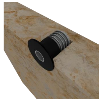
Figura A2.1.3: Posición de taco TR-MASA en el elemento del revestimiento.
