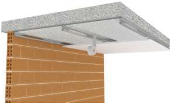
Figura 7.2: Instalación sobre falso techo con una cámara de aire realizada con los rastreles de soporte del falso techo.
