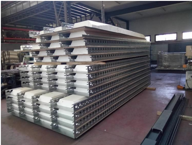
Figura 4.1: Apilamiento de prelosas del sistema SES™.
