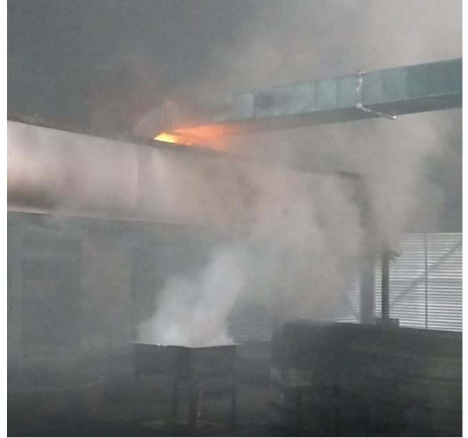
Figura 9.4: Estado del ensayo de extinción en campana y conducto (escala completa) durante la extinción.
