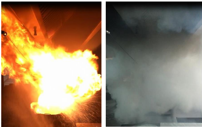
Figura 9.2: Secuencia de ensayo de salpicadura en extinción de wok.
