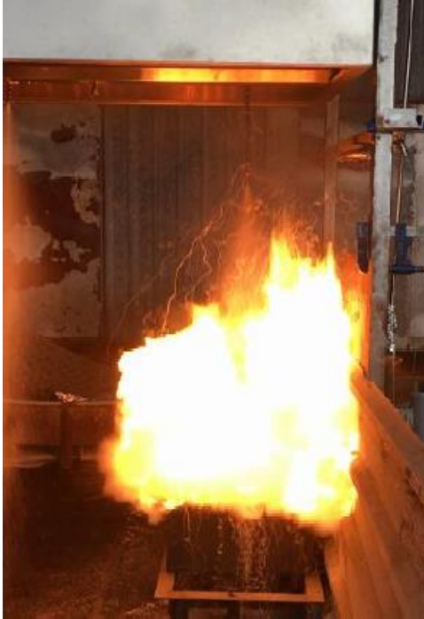
Figura 9.5: Activación automática y extinción de freidora 40F/40 a altura mínima.
