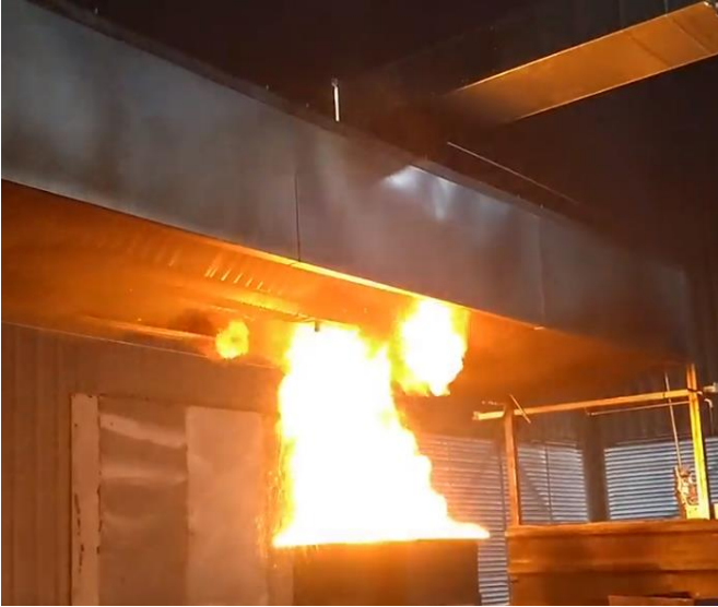
Figura 9.3: Preparación del ensayo de extinción en campana y conducto (escala completa); instante de la ignición del aceite en la campana.
