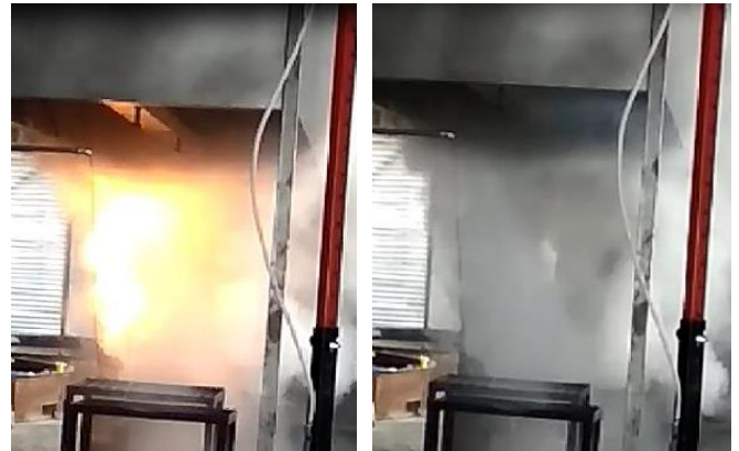
Figura 9.1: Secuencia de ensayo de extinción en freidora 40F/40.
