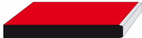
Figura 2.2: Panel con cantos biselados.
