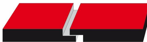
Figura 4.1: Junta con galce.
